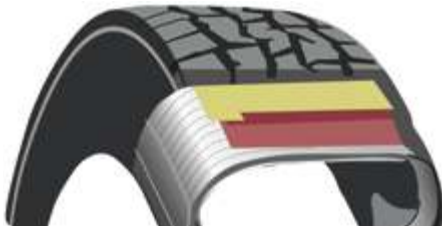
Structure d'un pneu radial (avec sa bande de roulement).
